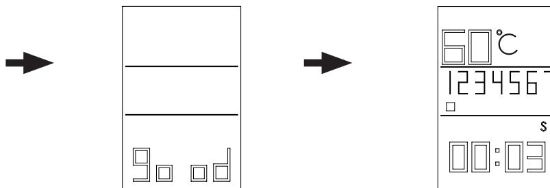
Die gewünschte Maximaltemperatur ist eingestellt und wird nicht überschritten, unabhängig davon welche evtl. höheren Werte in den Arbeitsprogrammen eingegeben sind.
